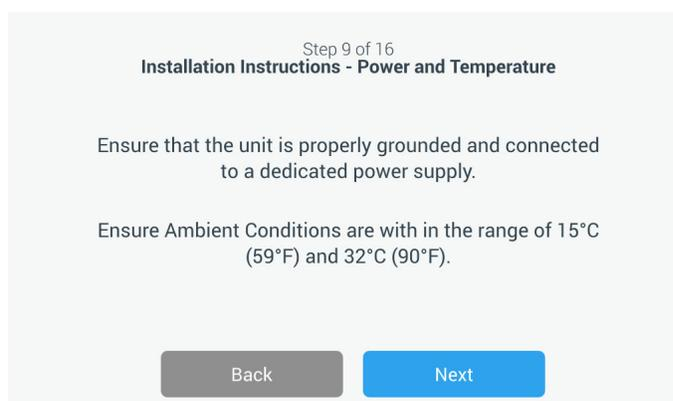
図 20. 取り付け指示（電源および温度）画面
